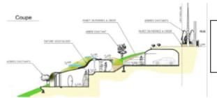
Le plan en coupe complète le plan de masse et permet de comprendre l'implantation du projet et ses incidences sur le terrain existant avant le projet
